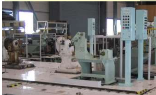
エンジン組み付け自動搬送機
